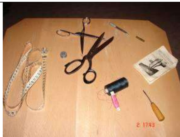
Šivalni stroj in pripomočki, katerih lastnica je Marta Knez Pušnik Na sliki so : ~merilni trak ~navijalka za sukaneč ~krojaške škarje ~priročnik za upravljanje šivalnega stroja ~izvijajč ~sukaneč ~igle
